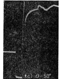
第 16 図 避雷器の制限電圧のオシ ログラム
