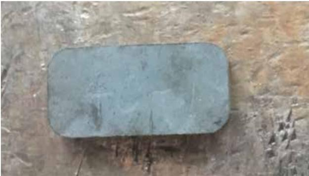
(a) 作製した焼結体 (成形荷重 400 kN)
