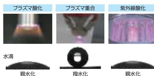
繊維表面をプラズマ処理すると、親水化や撥水・撥油化が起こり、衣服分野では吸汗速乾素材、透湿防水素材、防汚素材などをつくり出すことができます。産業資材では、他の材料との接着性が向上して繊維強化材料の高性能化を実現することができます。プラズマ処理は繊維に限らず全ての材料への適用が可能なので、様々な応用展開が可能です。
