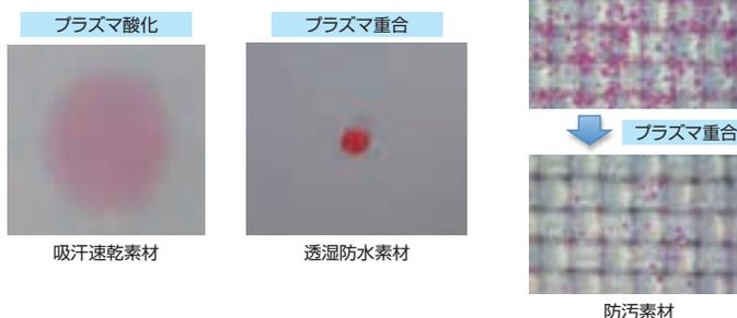
プラズマや紫外線を材料表面に照射すると、化学組成だけでなく、表面形態を変えることができ、新たな機能の出現に繋がります。例えばプラズマ酸化では、材料表面にナノレベルの凹凸が生成されます。また、プラズマ重合では、材料表面にサブミクロンレベルの粒状の突起をもつ薄膜が形成されます。
