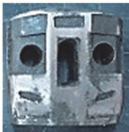
図 12 再設計 A パーツの焼結後の外観
