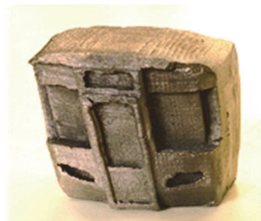
図8 焼結後の前面ブロックの外観 (焼結時間 180min.)
