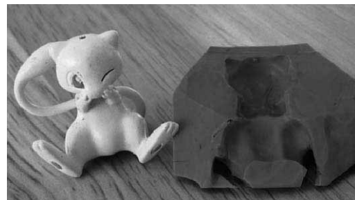
図 4 受講生が持ち込んだ原型と造形した成形型の例
