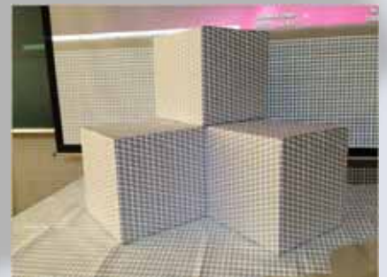
オブジェクトの配置調整 グリッド(方眼)を投影し箱の位置と映像の位置を合わせます
