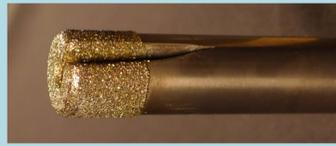
今回使ったドリルは、砥粒型のドリルを改良しています。切り屑を逃がすために溝を作りました。砥粒の部分は2層の構造になっており、1層目がはがれてしまっても2層目の砥粒でまた削ることができます。
