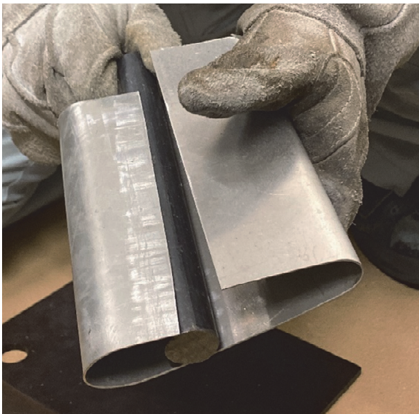
図1. 370℃まで加熱後温間成形した板材
