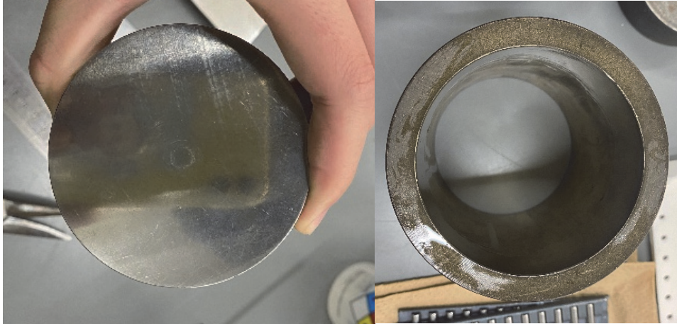
図 4. 使用したパンチ (左) とダイ (右)
