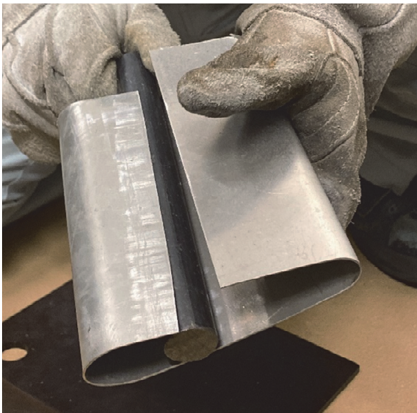
図1. 370℃まで加熱後温間成形した板材
