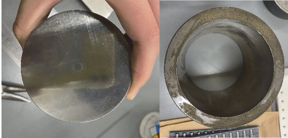
図 4. 使用したパンチ (左) とダイ (右)
