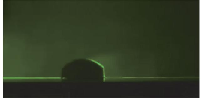
図 11. 流れの可視化実験の結果 (突起なし)
