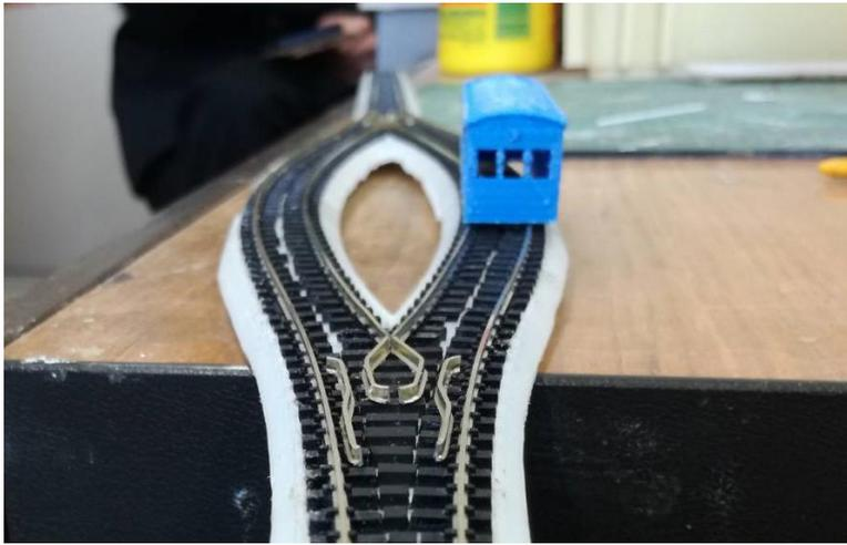
⑬ケーブルカーの線路も3Dプリンタで設計し、自作。線路を取り付けるのが大変だった。
