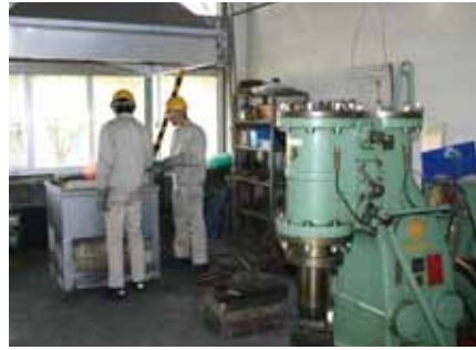
鍛造作業で使用する炉と排気装置
