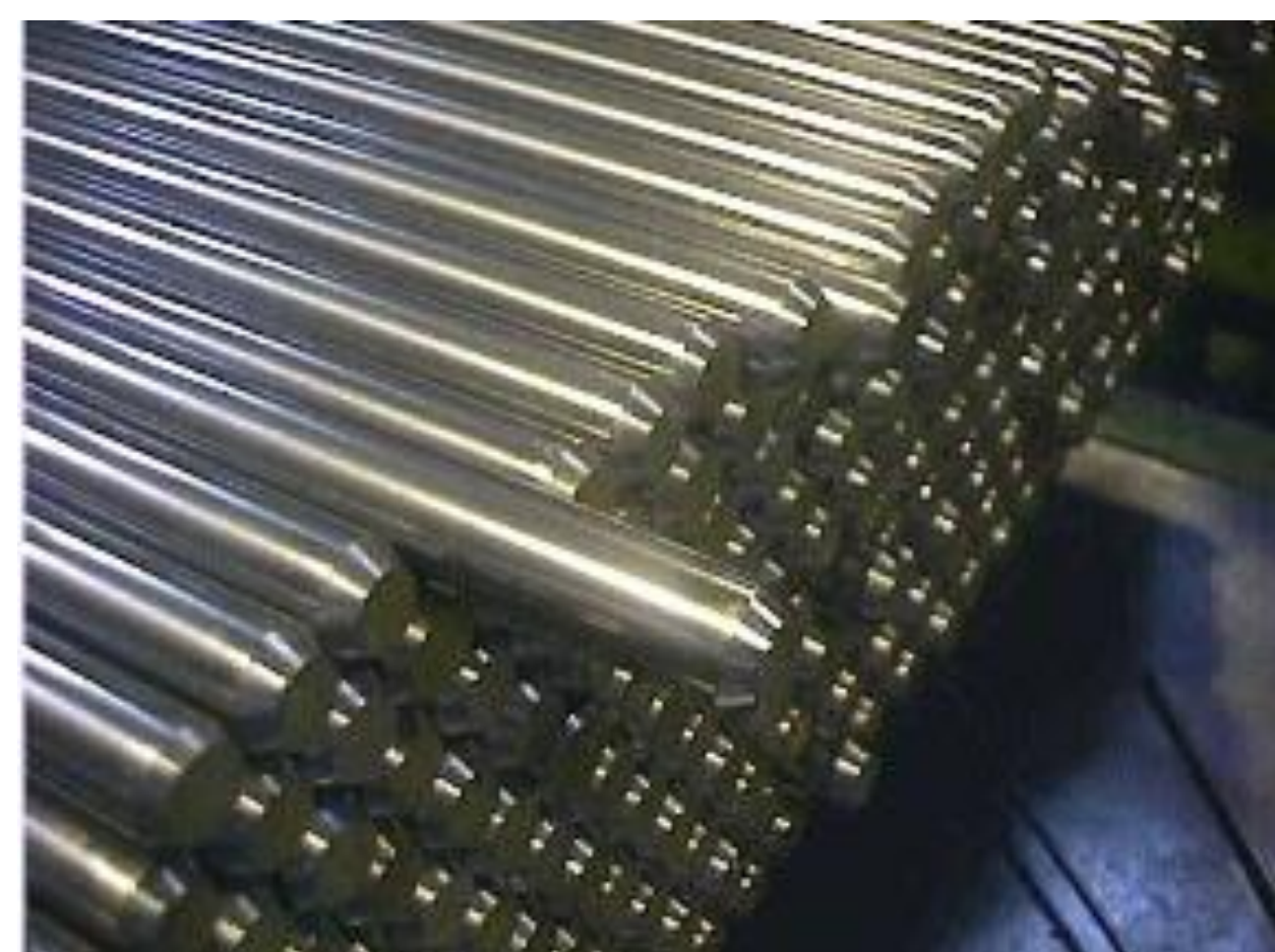
丸形断面形状の磨棒鋼
