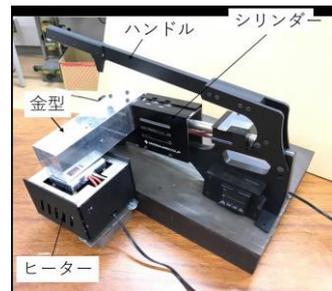
図1 簡易射出成型機
