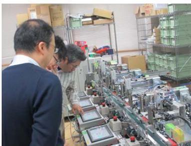
内容:モーション制御機能とシーケンス制御機能を一体化した最新のコントローラを使ったPLC制御の実習を基礎から行います。また生産ライン模擬装置によるワークや治具を使った移送・供給などを実習し、PLCによる自動機制御を実践的に学んで頂きます。
