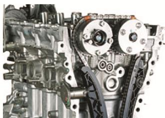
自動車エンジンの高性能化、軽量化、エコ化に寄与するタイミングチェーンドライブシステムを世界の自動車メーカーに提供しています。
