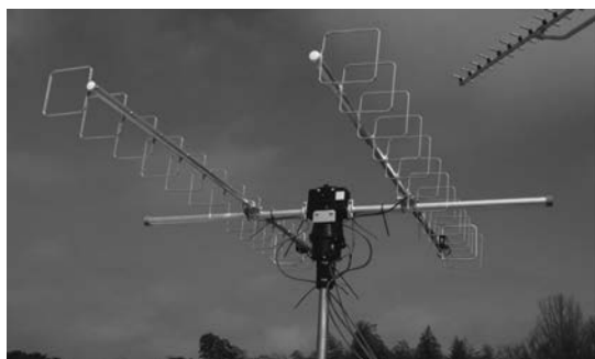
図10 設置と調整が完了したアンテナ
