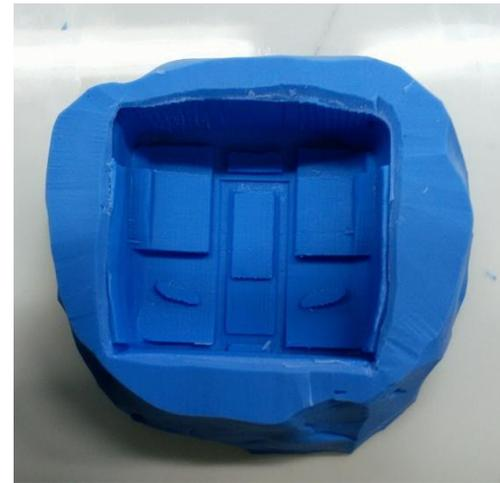
図6. 先頭ブロック(左:CAD図 中央:3Dプリンタで出力 右:シリコン型)
